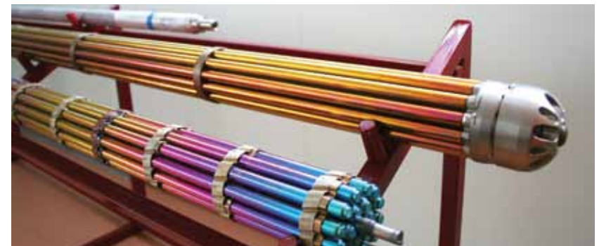
4 pav. RBMK reaktoriaus branduolinio kuro rinklės maketas Ignalinos atominėje elektrinėje
