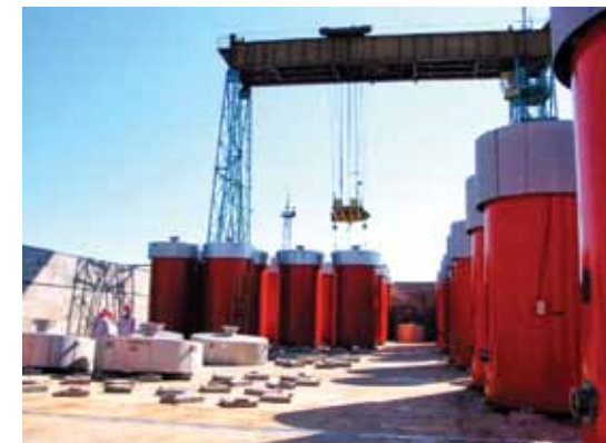
2 pav. Ignalinos AE saugykloje iškraunami konteineriai, skirti saugoti panaudotą kurą
