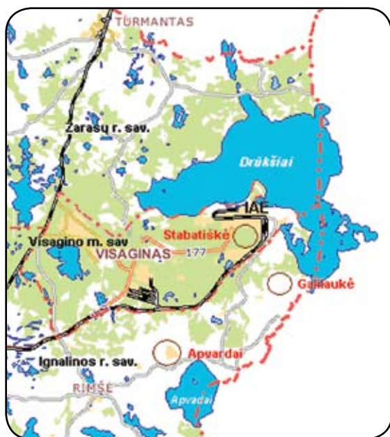
5 pav. Nagrinėjant kapinyno įrengimo vietas, pirmenybė teiktina vietovėms, esančioms arčiau atominės elektrinės. Tačiau kapinyną netikslinga statyti prie pat elektrinės, nes tai trukdytų elektrinės išmontavimo ir atliekų tvarkymo darbus. Be to, šalia elektrinės reikėtų palikti laisvą teritoriją naujai elektrinei statyti, jeigu toks sprendimas būtų priimtas
